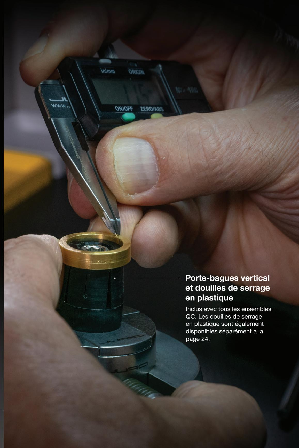
**Porte-bagues vertical et douilles de serrage en plastique**
